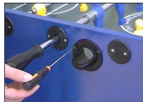
Inserire manualmente il bocchettone inserire le viti entro i fori e avvitare. Fare lo stesso con l'altro bocchettone.
